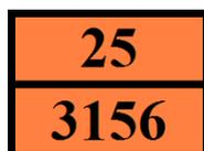
Restricciones en Tunel : E - Prohibido el paso por túneles de la categoría E.
